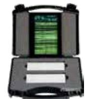
Paneles gemelos agrietados Eishin NiCr para PT
